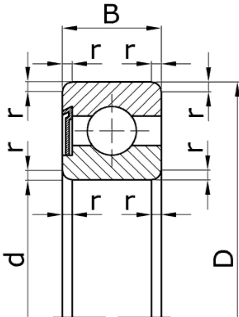
Характеристики подшипника 1060095 Параллельные ролики
