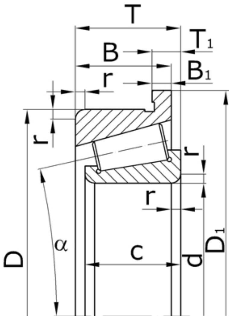
Характеристики подшипника 7620А Параллельные ролики
