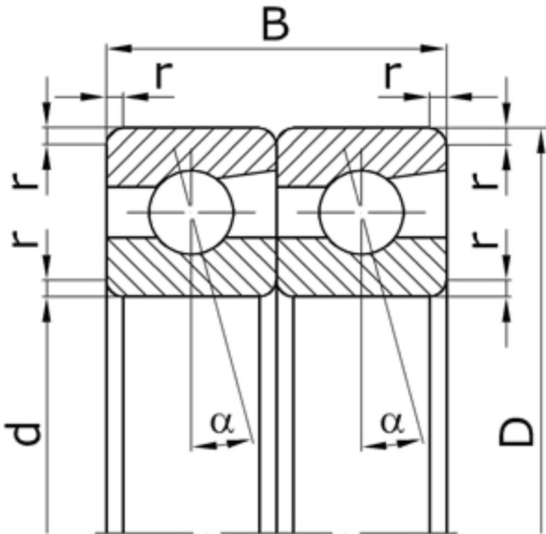
Характеристики подшипника 466224 Параллельно-осевые пары
