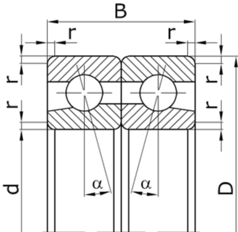
Характеристики подшипника 336217К Параллельные нагрузки
