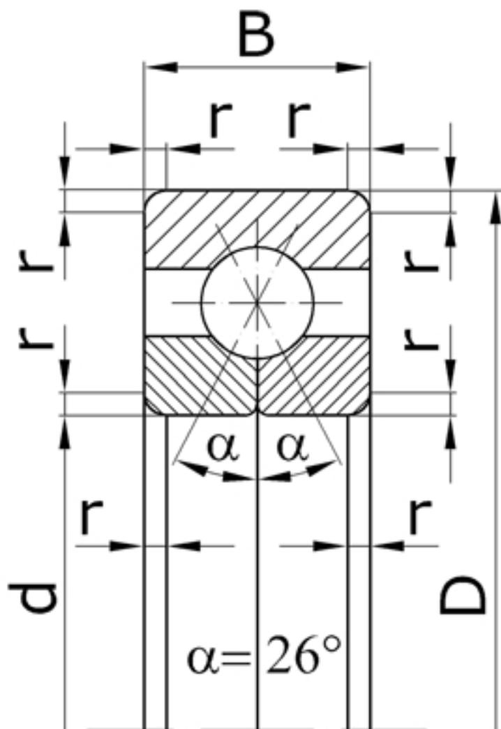
Характеристики подшипника 176334 Параллельные оси
