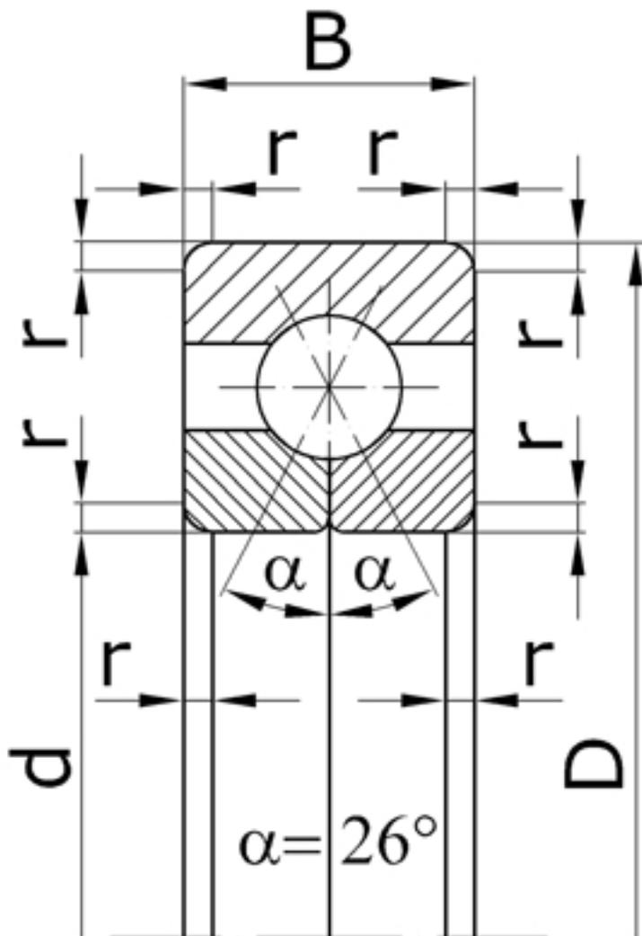
Характеристики подшипника 176105 Параллельные оси
