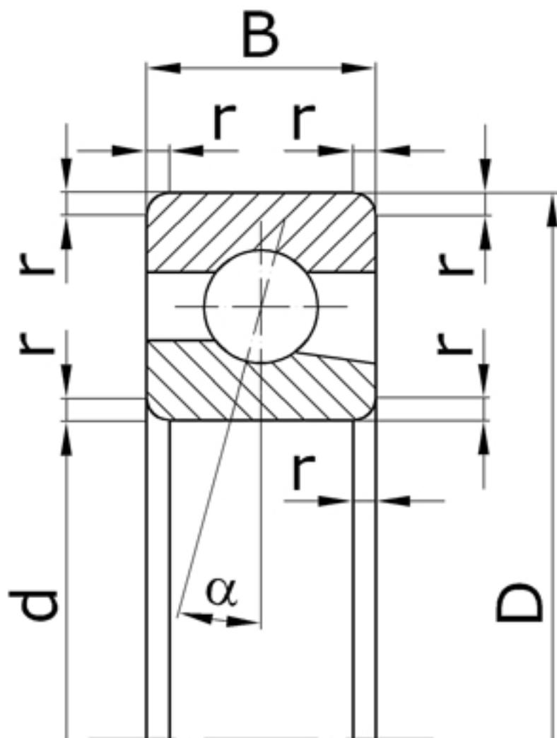
Характеристики подшипника 36115K7 Параллельные нагрузки
