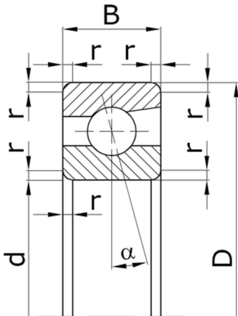
Характеристики подшипника 36203К6 Параллельно осевой плоскости
