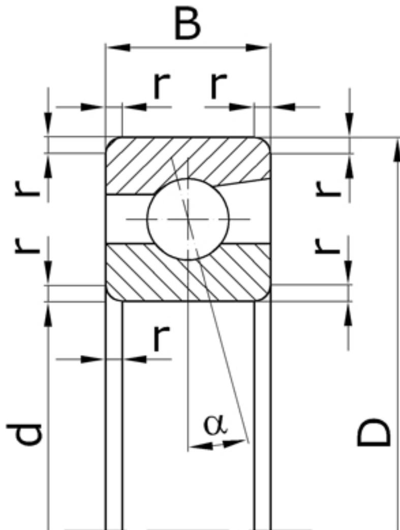
Характеристики подшипника 36136К6 Параллельно осевой
