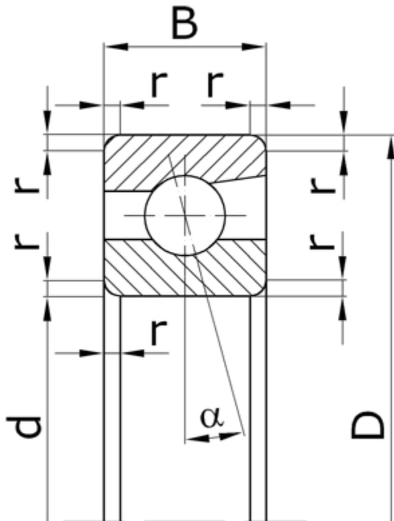
Характеристики подшипника 36109К6 Параллельно осевой плоскости
