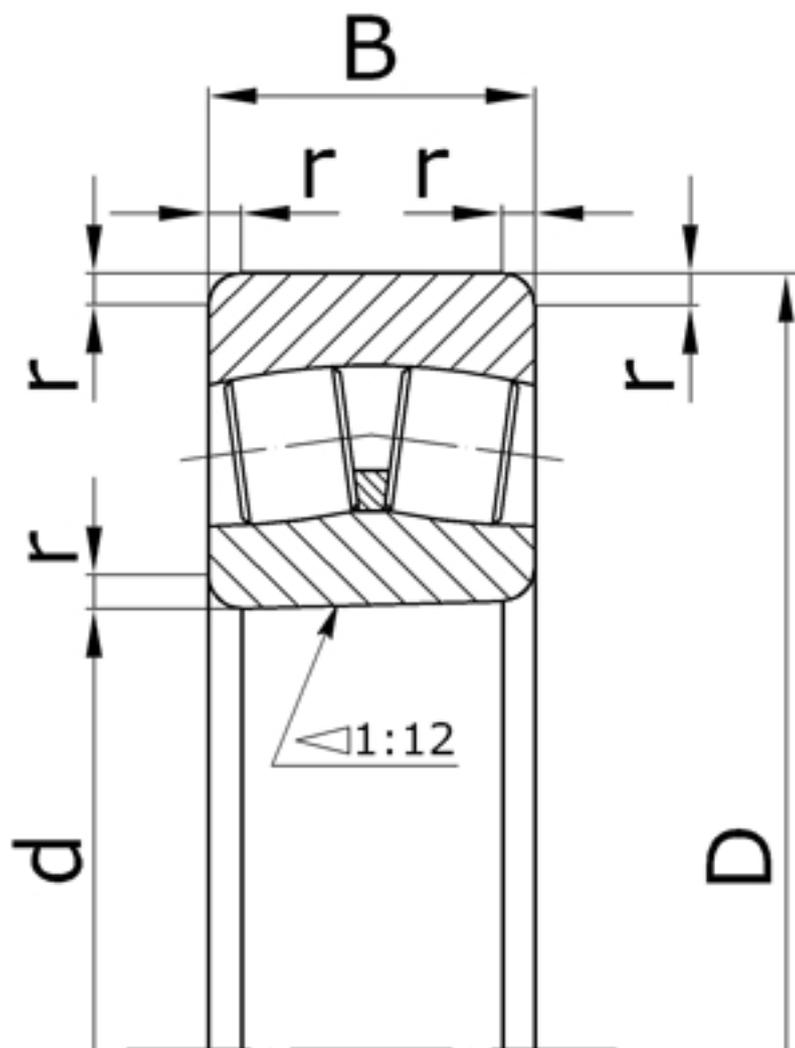
Характеристики подшипника 153544Н Параллельные ролики
