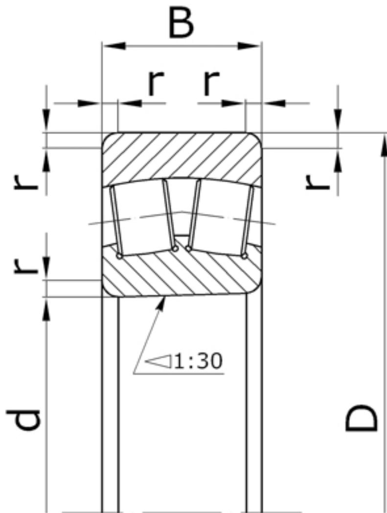
Характеристики подшипника 4113168 Параллельные ролики
