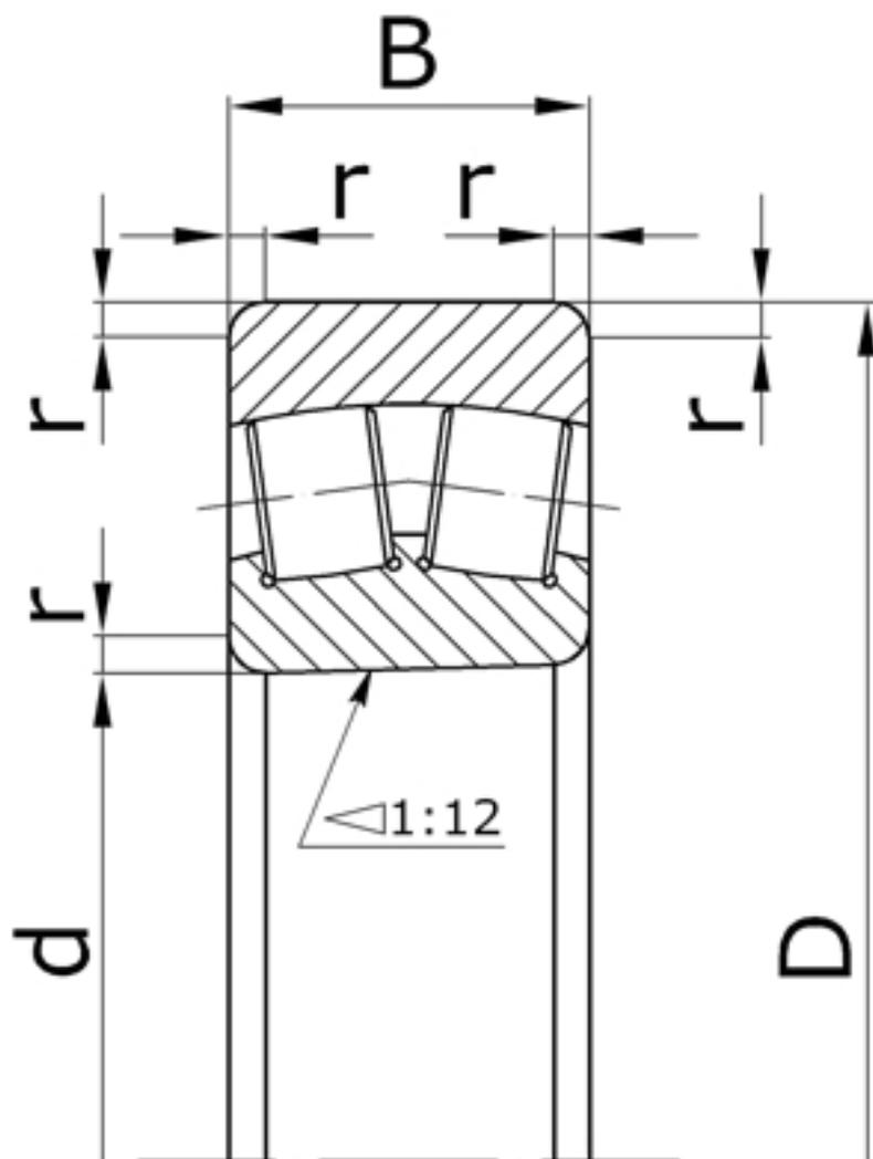
Характеристики подшипника 3113228 Параллельные ролики
