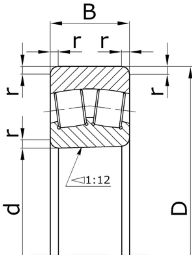
Характеристики подшипника 3113134 Параллельные ролики
