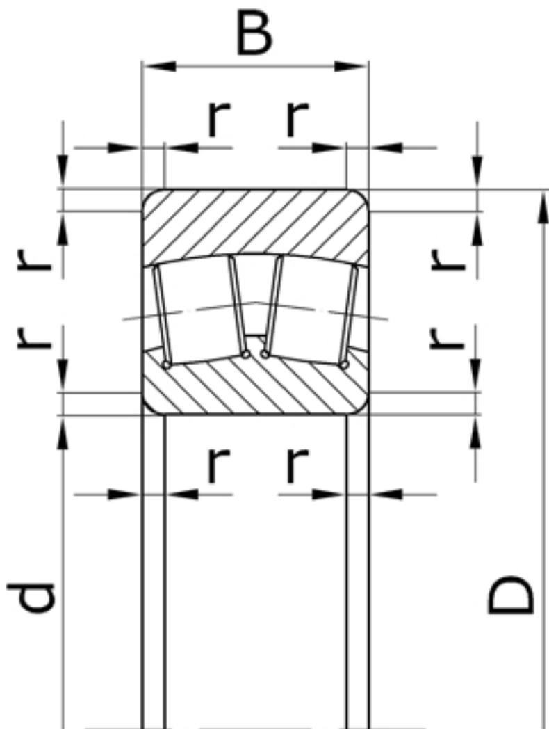
Характеристики подшипника 4003748 Параллельные ролики
