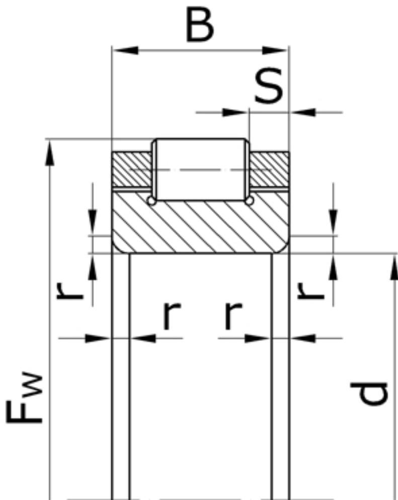
Характеристики подшипника 502307 Параллельные ролики
