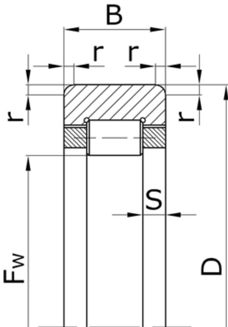
Характеристики подшипника 292144Н Параллельно-цилиндровый
