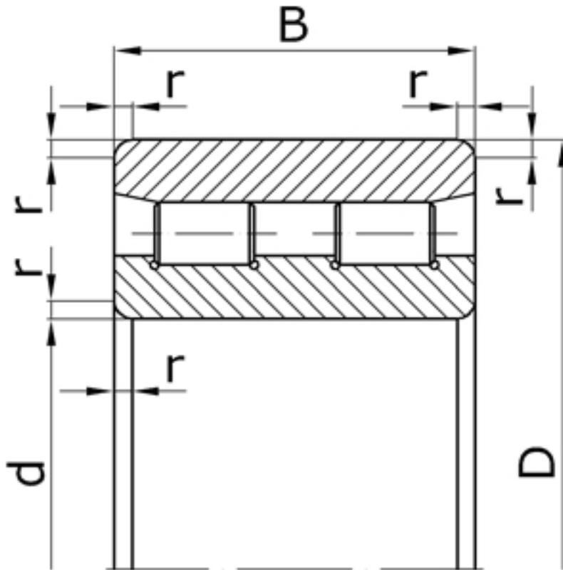
Характеристики подшипника 3282160 Параллельные ролики
