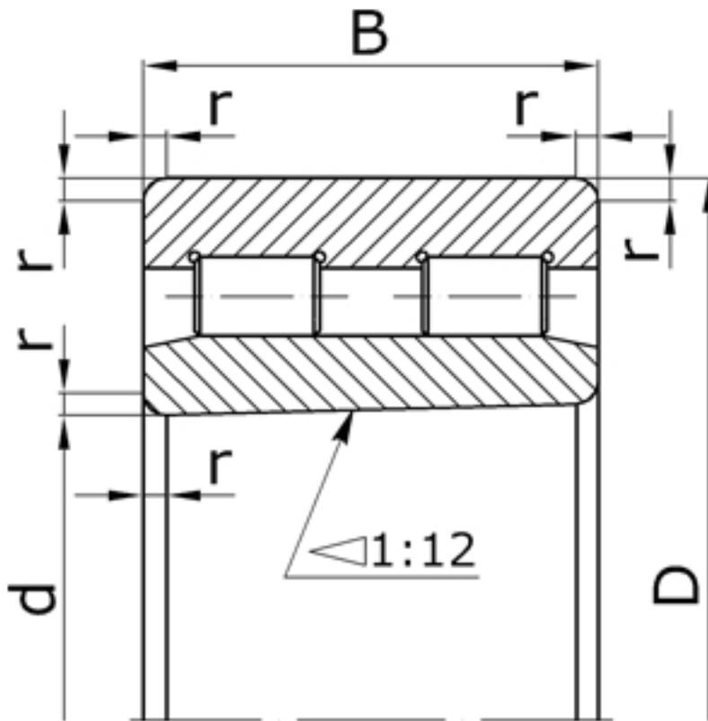
Характеристики подшипника 4162980 Параллельные ролики
