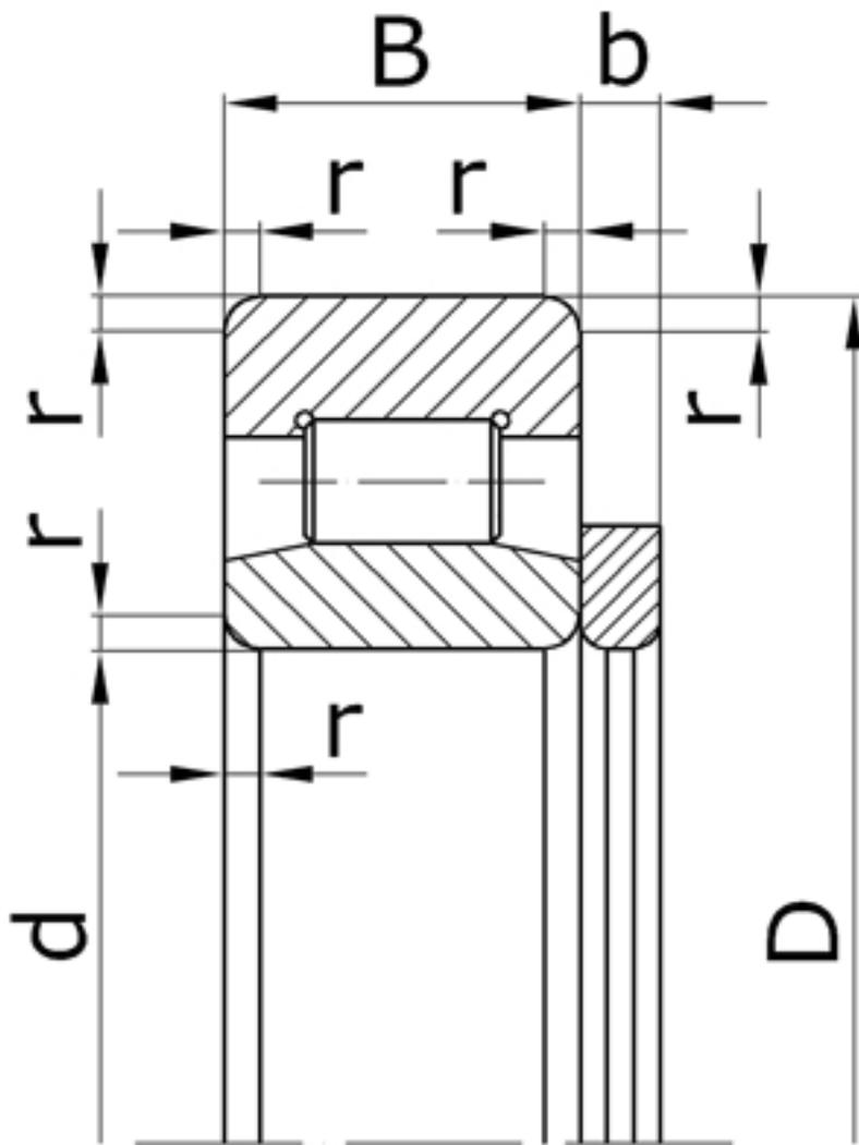
Характеристики подшипника 152624 Параллельно-цилиндровый
