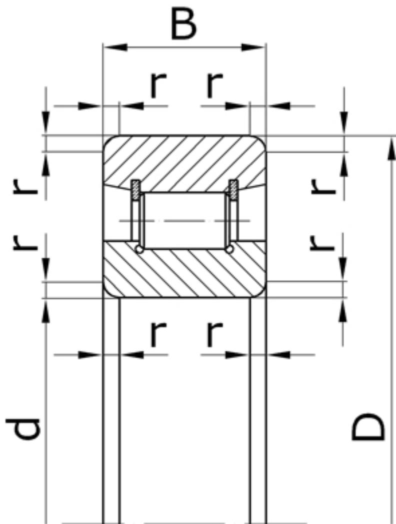
Характеристики подшипника 102307 Параллельные ролики
