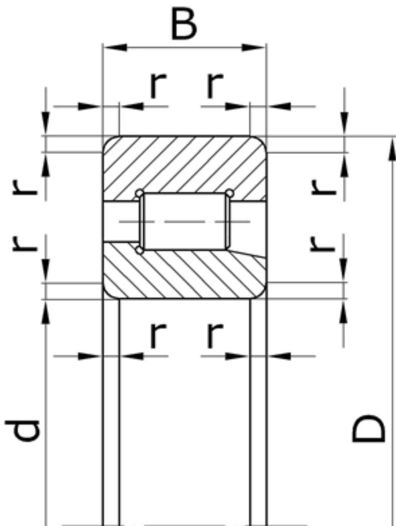
Характеристики подшипника 42211 Параллельно-цилиндрические
