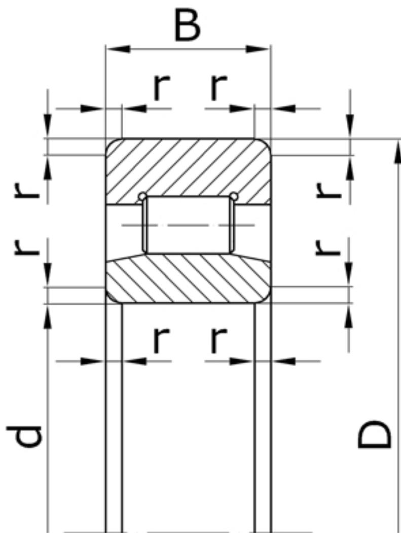
Характеристики подшипника 32124 Параллельно-цилиндровый
