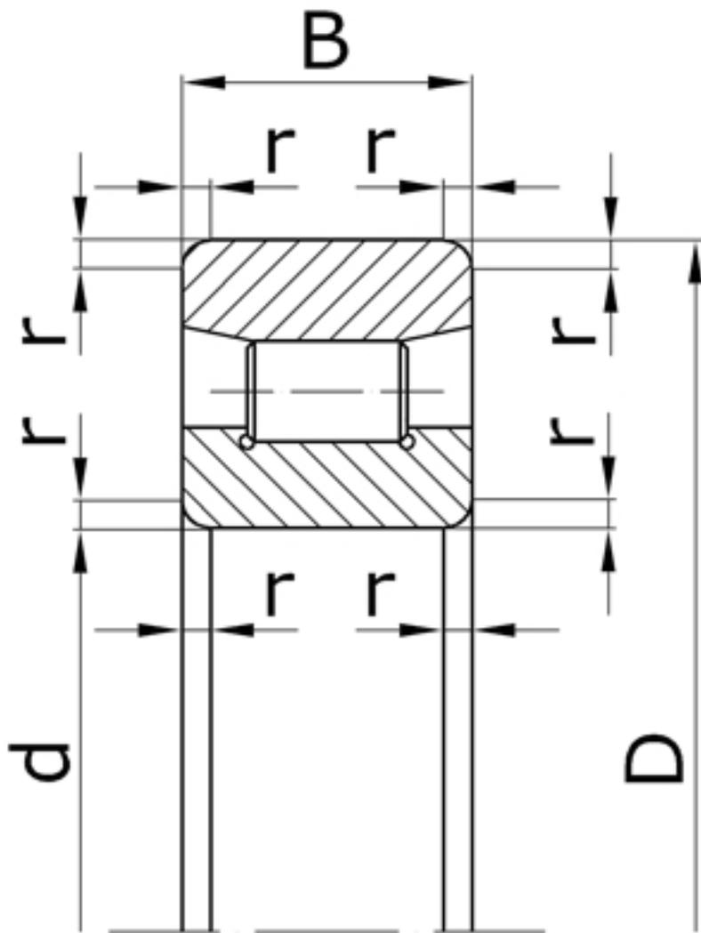
Характеристики подшипника 2202 Параллельные ролики
