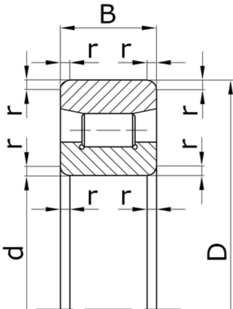
Характеристики подшипника 2134 Параллельно-цилиндровый
