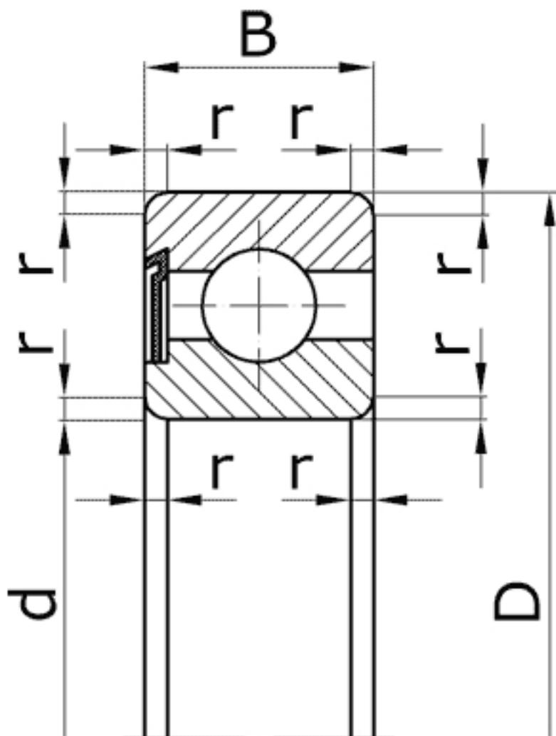
Характеристики подшипника 160029 Параллельные оси
