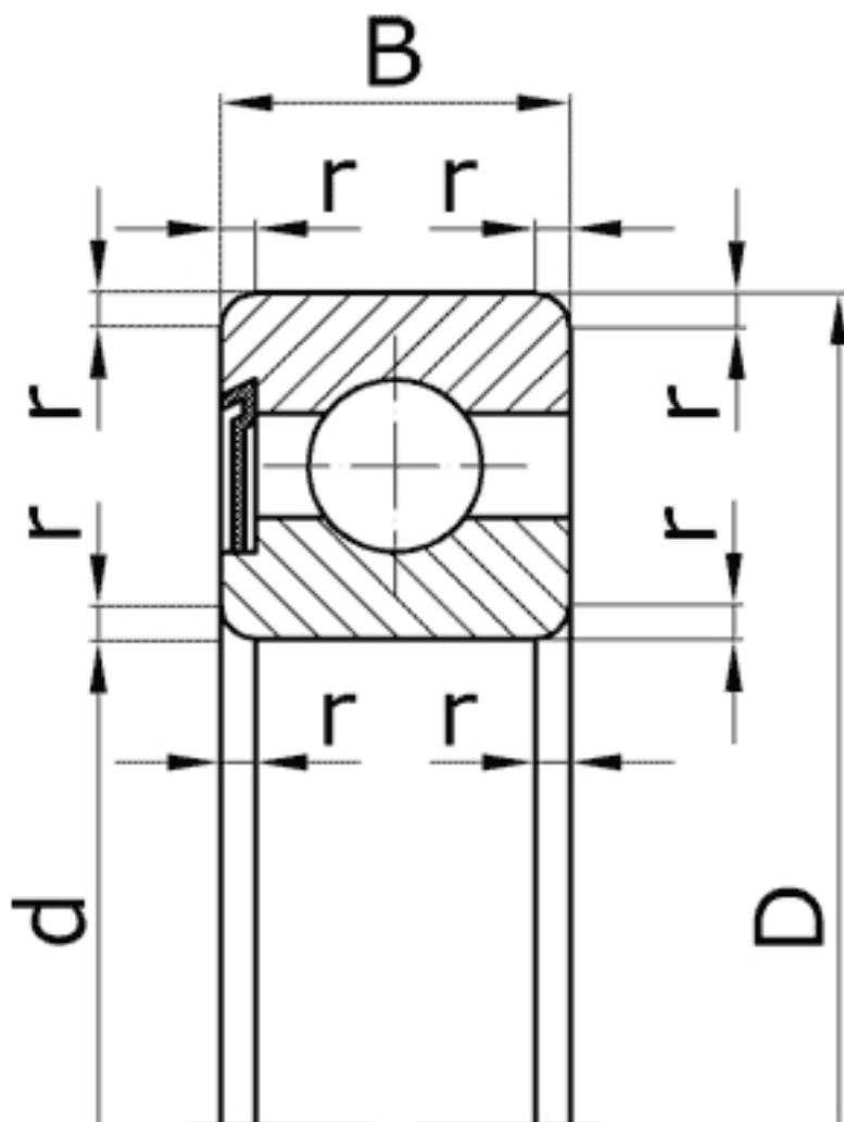
Характеристики подшипника 160025 Параллельные оси
