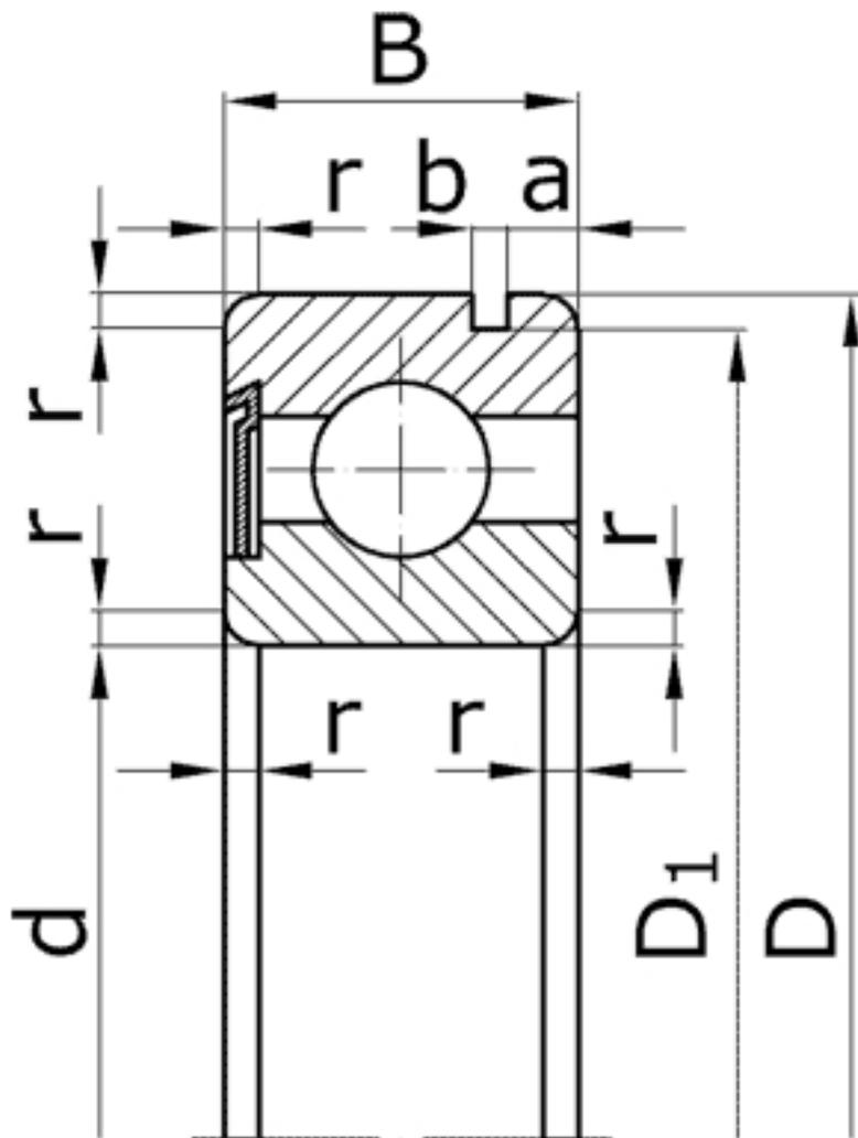
Характеристики подшипника 150100 Параллельные оси
