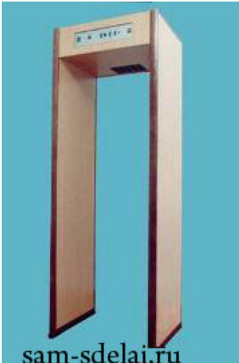
Принцип действия описываемого устройства основан на влиянии вихревых токов, возникающих в металлическом предмете, на добротность катушки, создающей магнитное поле.
