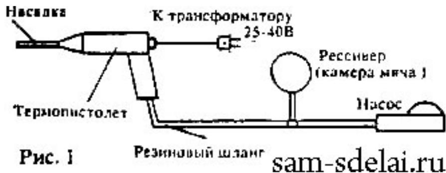
Данная конструкция может быть полезна для автолюбителей, при ремонте пластмассовых деталей.
