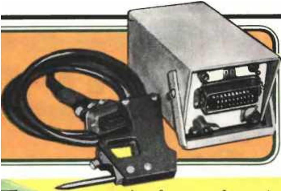
Переносной самодельный сварочный аппарат для точечной сварки с выносным сварочным пистолетом предназначен для приваривания листовой нержавеющей и обычной стали толщиной 0,08...0,15 мм к массивным стальным деталям, а также для соединения сваркой стальной проволоки диаметром до 0,3 мм.
