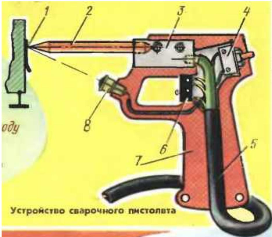
Устройство сварочного пистолета
