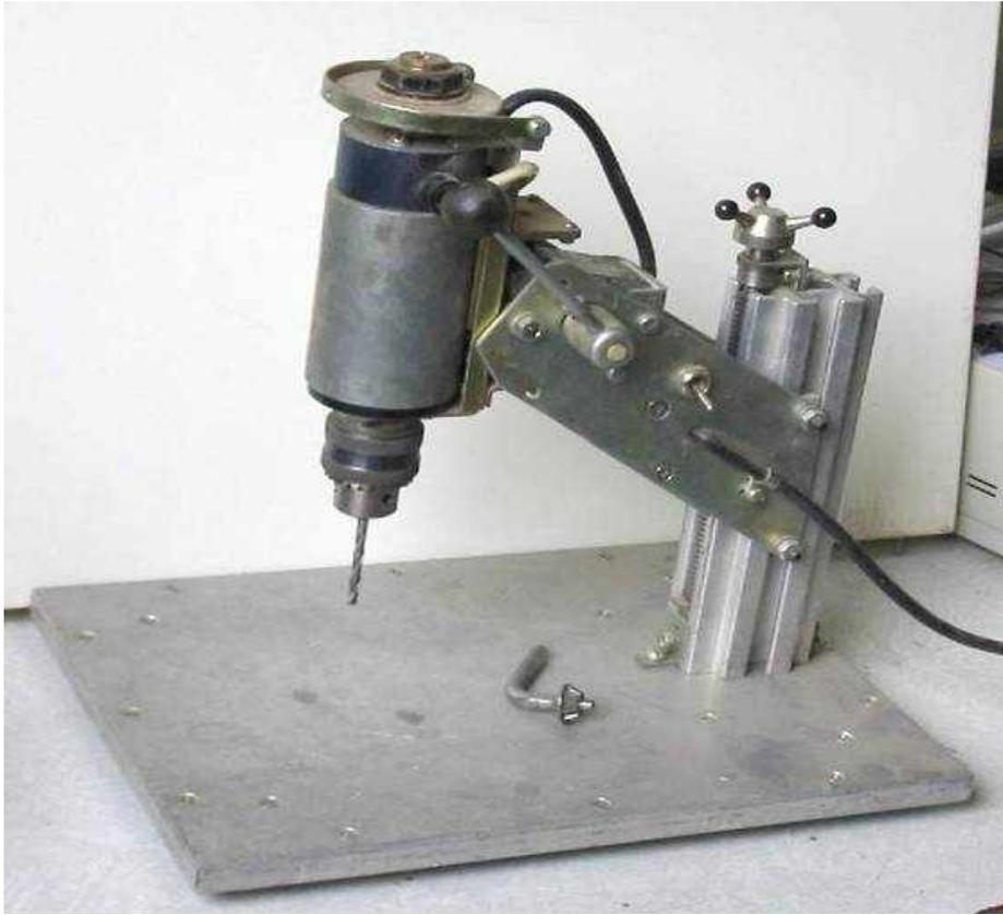
Сверлильный станок под патрон 2а. Стойка из алюминиевого профиля в нем червячная передача, с ее помощью каретка на подшипниках перемещается на 80 мм под сверла разной длины.
