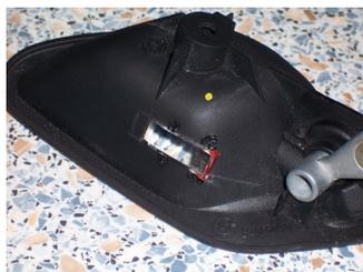
Приставив к светофильтру светодиод с пропаянными проводами и сопротивлением, залил всё хозяйство термоклеем из пистолета.
