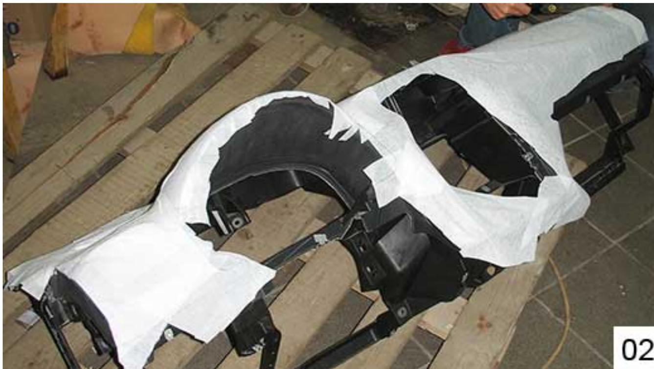
02. У каждого мастера перетяжки салона автомобиля кожей есть свои особенные приемы изготовления выкроек с поверхности торпеды. Кто-то, например, использует «Аракал» – самоклеящую пленку, а вот в нашем случае на поверхность детали наклеивался флизелин. Причем, не все используют клеящее свойство флизелина и соединяют лоскуты утюгом. Наш мастер наклеивал флизелин «резиновым» клеем из баллончика (спрея).
