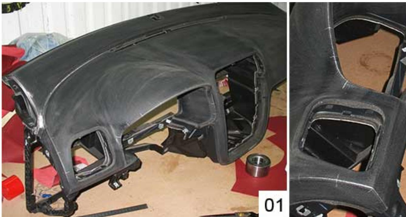
01. Далее займемся поверхностью, на которую собираемся наклеивать кожу. Всю торпеду обезжириваем очищенным бензином «Галоша» (Нефрас) и хорошо ошкуриваем крупной наждачной бумагой.
