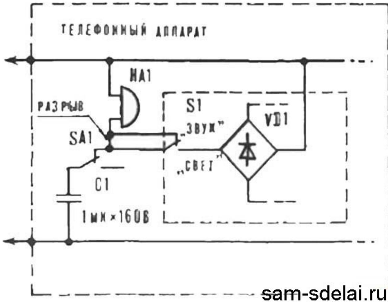
Рис. 1. Световой индикатор телефонных звонков. А - звуковой звонок; Б - световой звонок; В - звуковой и световой звонок. С - звуковой и световой звонок с реле.
